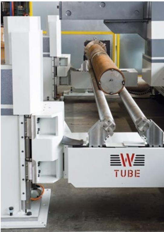
Il dispositivo W-TUBE consiste in un prolungamento a sbalzo della trave porta torcia per tagliare tubi di sezione tonda di diametro massimo pari a 600 mm, oltre a tubolari quadrati o rettangolari e a profili aperti, alloggiati su N. 2 (o più, a seconda della lunghezza) lunette motorizzate su 2 assi in modo da sostenere diversi diametri.
