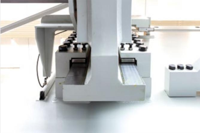
Per macchine di grande dimensioni viene adottato un sistema di scorrimento a doppia guida a lardoni autolubrificanti, per assicurare assoluta precisione nonostante gli elevati tonnellaggi applicati.
