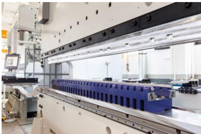
Per la piegatura di materiali di alto spessore e con carico di rottura elevato (materiali alto-resistenziali), sono disponibili utensili speciali, come la matrice a cava (V) variabile presente in foto.
