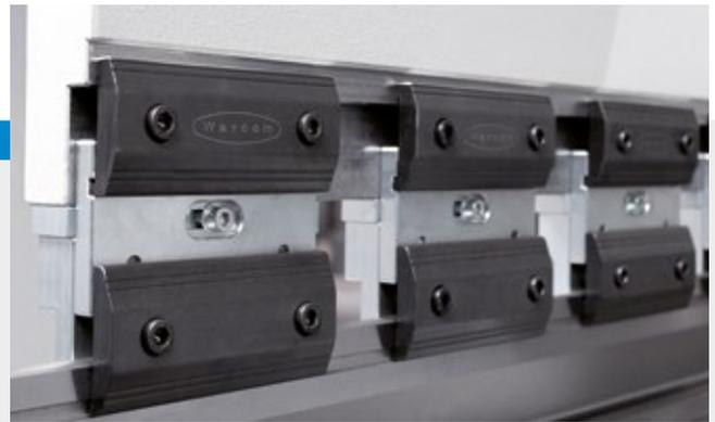
Intermedio standard con bloccaggio manuale.
