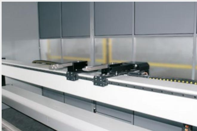
Il registro M3 viene montato sulla serie FUTURA. È equipaggiato di due torrette di riscontro montate su guide lineari movimentabili dalla parte anteriore della macchina.
