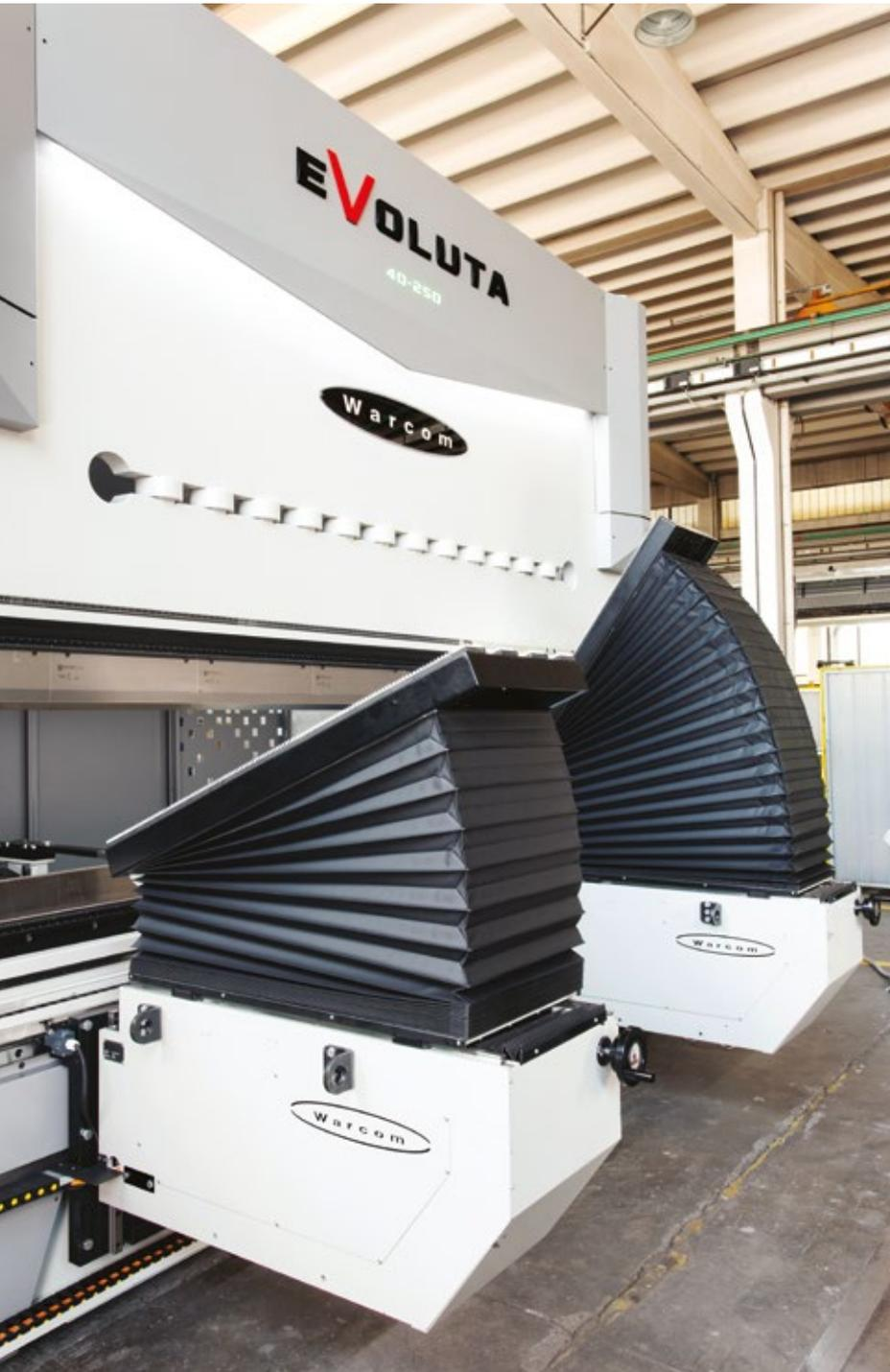
Accompagnatori lamiera anteriori che agevolano la lavorazione di lamiere di medie e grandi dimensioni. Sono gestiti dal CNC (A1-A2) e perfettamente sincronizzati con gli assi di piega (Y1-Y2). Regolabili manualmente in altezza e profondità in base alla matrice utilizzata. Per i supporti A1-A2 sono disponibili anche le motorizzazioni degli assi verticale (altezza matrice) e orizzontale (avvicinamento matrice).
